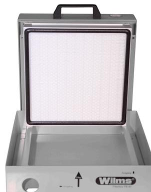
3. Achten Sie darauf den neuen HEPA-Filter mit der richtigen Seite nach oben einzulegen. Diese ist sowohl auf den Filtern als auch auf dem Gehäuse der Filterbox FB 40 mit einem Pfeil markiert.
